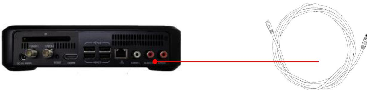
Verbinden Sie mit dem beigelegten LAN-Kabel das VDR-XBMC Mediacenters mit Ihrem Internet-Modem/Router
