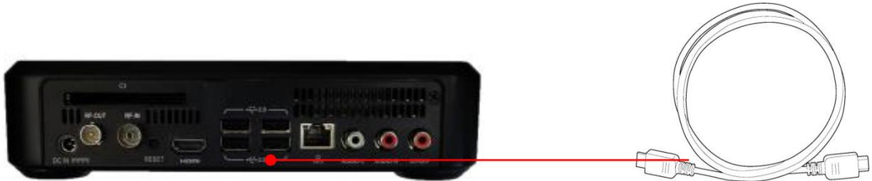
Verbinden Sie das VDR-XBMC Mediacenters und Ihr TV-Gerät mit dem beigelegten HDMI Kabel
